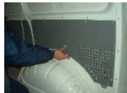
Block wie gewünscht in das Fahrzeug stellen, aber möglichst nah zur Karosseriewand positionieren (ein direkter Kontakt ist wegen Quietsch- bzw. Klappergeräuschen zu vermeiden) und anschließend parallel zur Fahrzeuglängsachse ausrichten.
