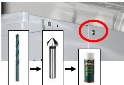
Die Bohrung leicht ansenken und das Blech an der Bohrung nachlackieren oder mit Zinkspray verzinken. Lack antrocknen lassen und die beiden Wannenteile mit der Linsenflanschkopfschraube M5 und der Sperrzahnschraube M5 wieder verschrauben.
