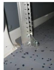
Globelyst ins Fahrzeug stellen und an den Befestigungspunkten am Boden ausrichten. Wenn alle Punkte passen, werden diese mit in untenstehender Tabelle aufgeführten Schrauben handfest verschraubt.
