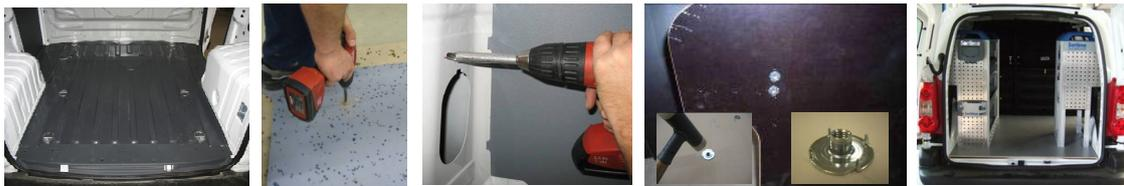
4. Einrichtungsblöcke und Sortimo Bodenplatte aus dem Fahrzeug entfernen
