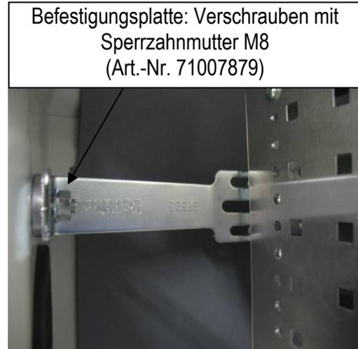
Nach Verschraubung der BFE an der Karosserie auch die M6 Schrauben/ Muttern zur Befestigung des BFE am Block festziehen (Drehmoment 7-8 Nm).
