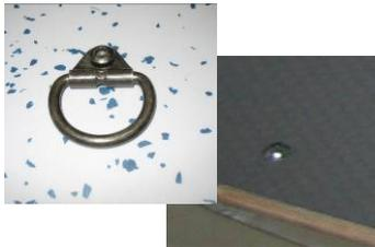
Sodann die Schrauben in die Zurrpunkte handfest einschrauben und so den Boden im Fahrzeug fixieren.
